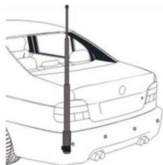
Véhicule équipé d'une antenne radio de forte puissance.
