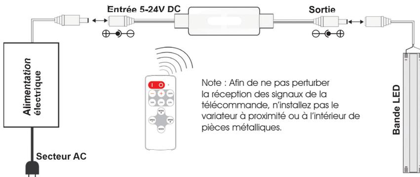
Note : Afin de ne pas perturber la réception des signaux de la télécommande, n'installez pas le variateur à proximité ou à l'intérieur de pièces métalliques.
